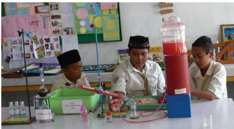
Siswa MTsN Nglawak Kabupaten Nganjuk sedang melakukan praktik penyulingan untuk menghasilkan aromatherapy .
